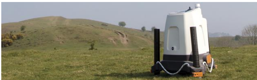
Esempio di wind lidar per misure del profilo verticale del vento.
